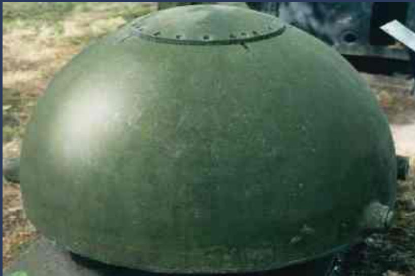
Немецкая донная мина типа RMA, предназначенная для постановки с надводных кораблей
