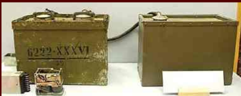
Блок управления «Ф-10»: слева — ящик «А» и прибор «А» (дешифратор), который извлечён из коробки и выложен перед ней; справа — ящик «Б». Между собой ящики «А» и «Б» соединены кабелем питания
