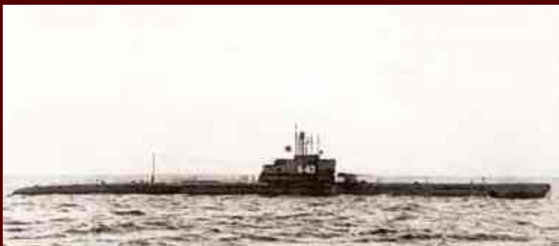
Большая подводная лодка проекта 611 на момент вступления в состав флота. Артиллерийское вооружение впоследствии было демонтировано
