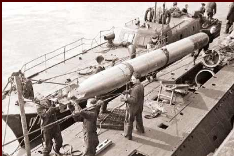
Погрузка торпед на подводную лодку
