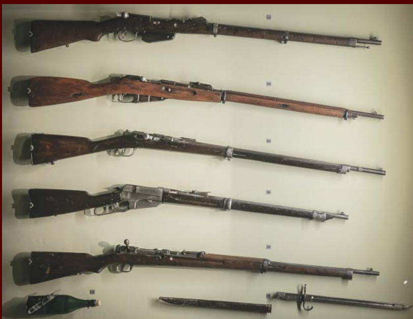
Личное оружие военнослужащих дивизий народного ополчения. 1. Винтовка системы Манлихера образца 1895 г., калибр 8 мм (Австро-Венгрия); 2. Винтовка системы Мосина образца 1891/1930 гг., калибр 7,62 мм (Россия — СССР); 3. Винтовка системы ГРА 1874 г., калибр 11 мм (Франция); 4. Винтовка системы Винчестер образца 1895 г., калибр 7,62 мм (США); 5. Винтовка системы Арисака образца 1905 г., калибр 6,5 мм (Япония); 6. Штык для винтовки Арисака образца 1905 г.; 7. Бутылка с зажигательной смесью № 1 (воспламенительная ампула не вставлена в бутылку)
