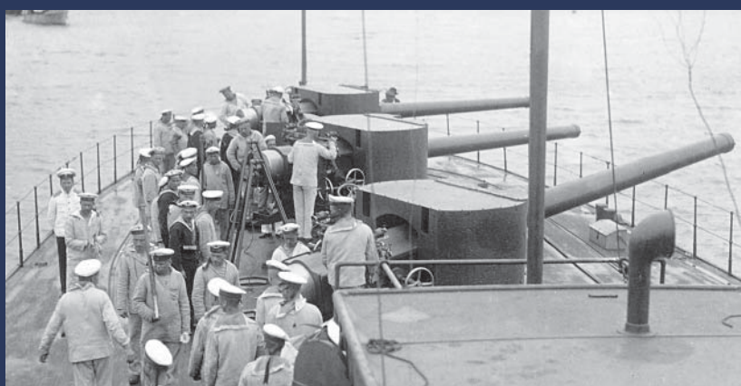
Артиллерийское учение 6-дм орудий длиной в 45 калибров на канонерской лодке «Грозный». На казённой части орудий хорошо заметны сдвоенные прицелы системы Обуховского завода образца 1908 г. 1916 г. Из собрания автора
