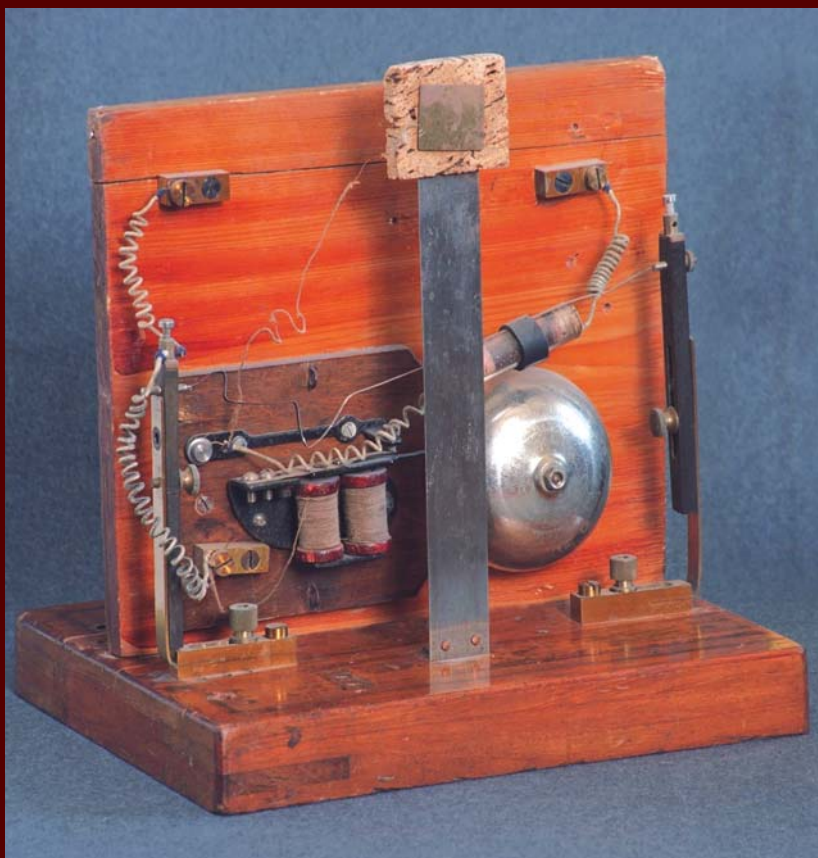
«Прибор для обнаружения и регистрирования электрических колебаний» — радиоприёмник А.С. Попова Фонды ВИМАИВиВС
