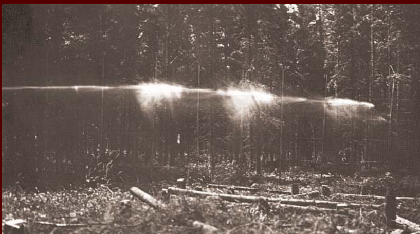
Испытания экспериментального прибора Военно-химической академии РККА для производства струеметания: его дальность в запечатлённый на снимке момент составила до 30 м (при давлении в резервуаре 10 атм, диаметре наконечника брандспойта 10,06 мм и угле возвышения брандспойта 10°) 1934 г. ЦАМО РФ. Ф. 38. Оп. 11355. Д. 2839. Л. 28.
