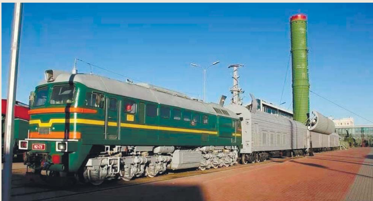
Пусковой модуль БЖРК: тепловоз ДМ-62, вагон-электростанция (система отвода и закорачивания контактной сети поднята), вагон с ракетой, вагон — пункт управления пуском
