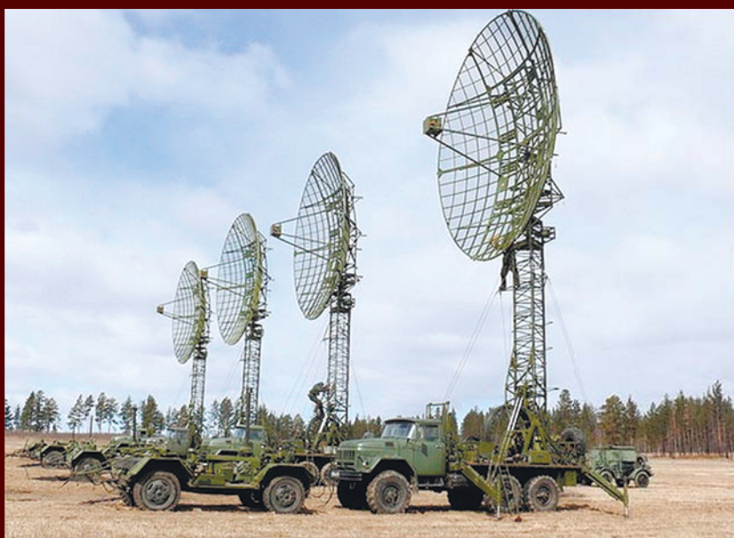
Станция тропосферной связи Р-410-5,5
