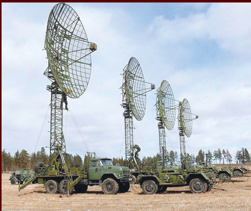
Станция тропосферной связи Р-410
