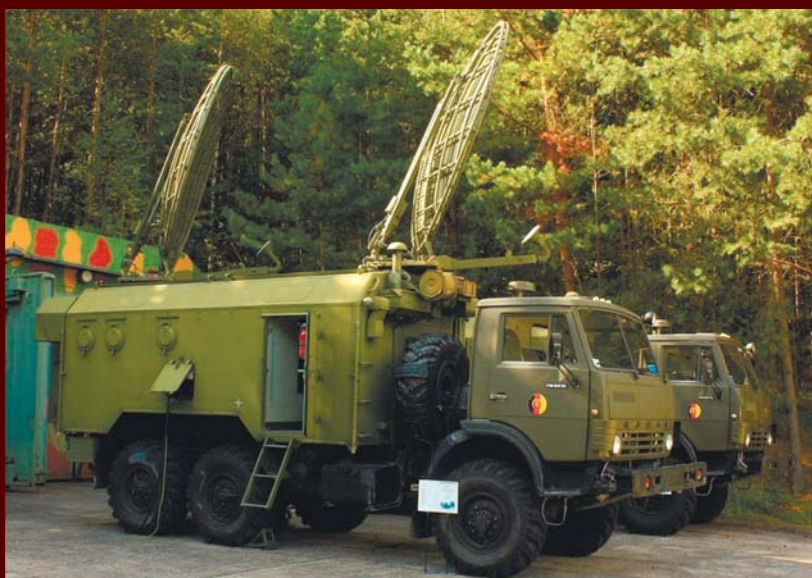
Станция тропосферной связи Р-417
