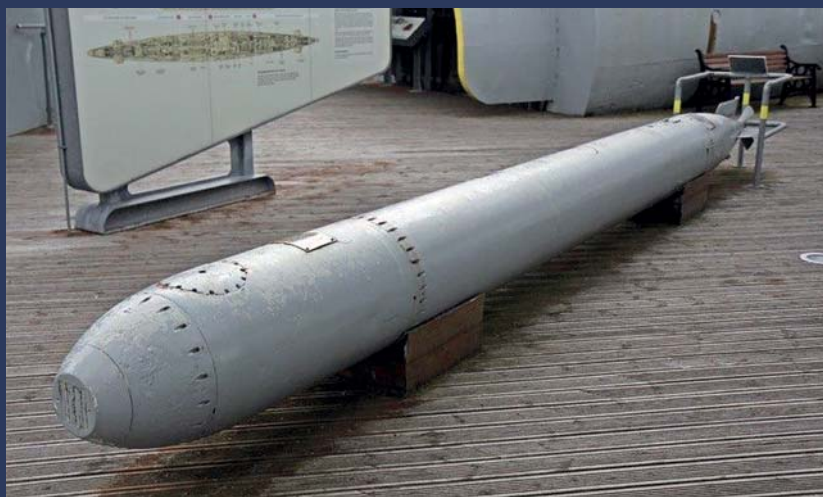
Немецкая акустическая самонаводящаяся торпеда «Цаункёниг» (Zaunkönig) — экспонат музея подводки U-534 в Биркенхэде, Великобритания
