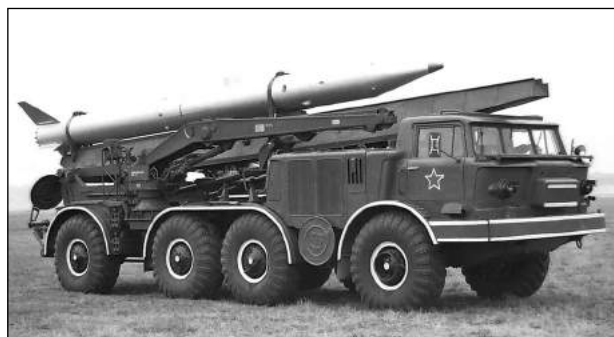
Пусковая установка 9П113 с учебно-тренировочной ракетой 9М21УТ
