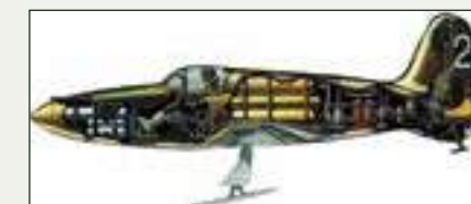
Внутренняя конструкция БИ-1
